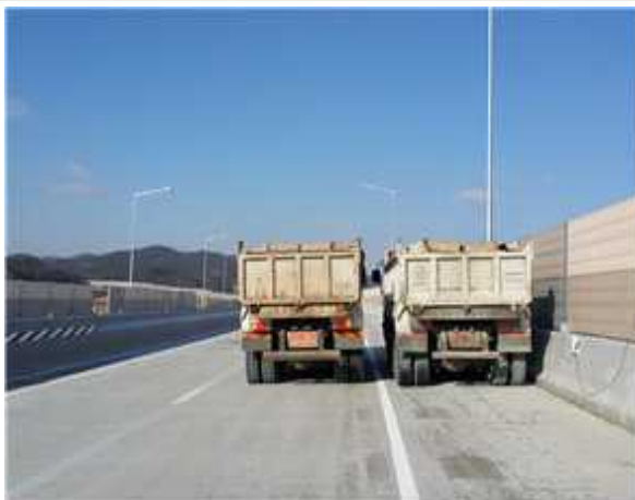
정적 재하시험 전경
